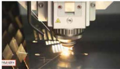
El sistema de fibra óptica tiene una gran ventaja debido su mayor eficiencia eléctrica y a la facilidad de conducir el haz con sólo mover la fibra óptica, sin necesidad de espejos. El láser de fibra consigue cortar metales con gran eficiencia eléctrica aunque la calidad del borde no es tan suave como el láser de CO<sub>2</sub> en materiales superiores a 5mm de espesor y su velocidad de corte es algo inferior.
